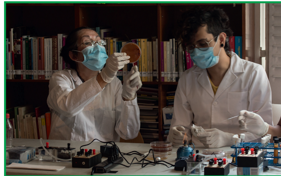
Aufbau einer mikrobiellen Energiezelle und eines Analog/Digitalsynthesemoduls [CV auf Midi] mit Teensy 3.5. © Interspecifics
